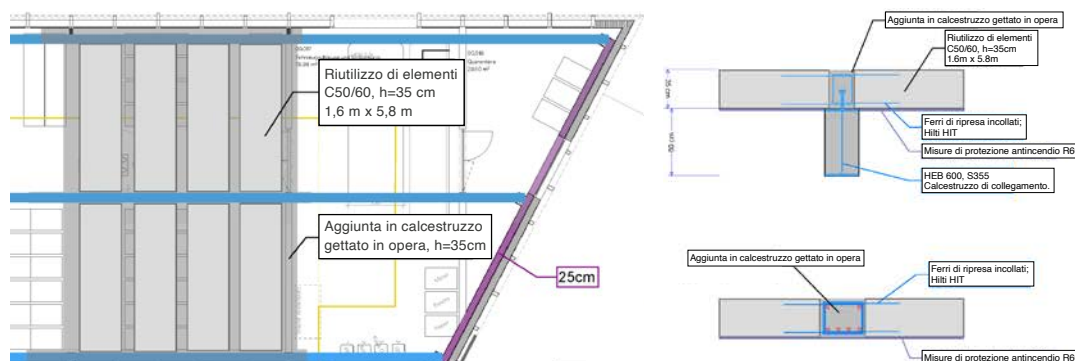
Piano per il riutilizzo degli elementi in calcestruzzo (illustrazioni: NEUME x WV Architektur di Basilea e ZPF Structure AG di Basilea)
