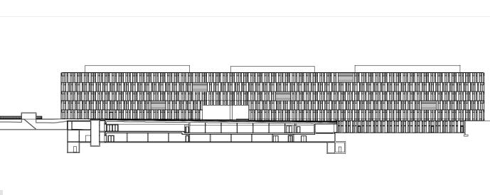
2 Nordfassade mit Längsschnitt Verbindungsgeschoss
