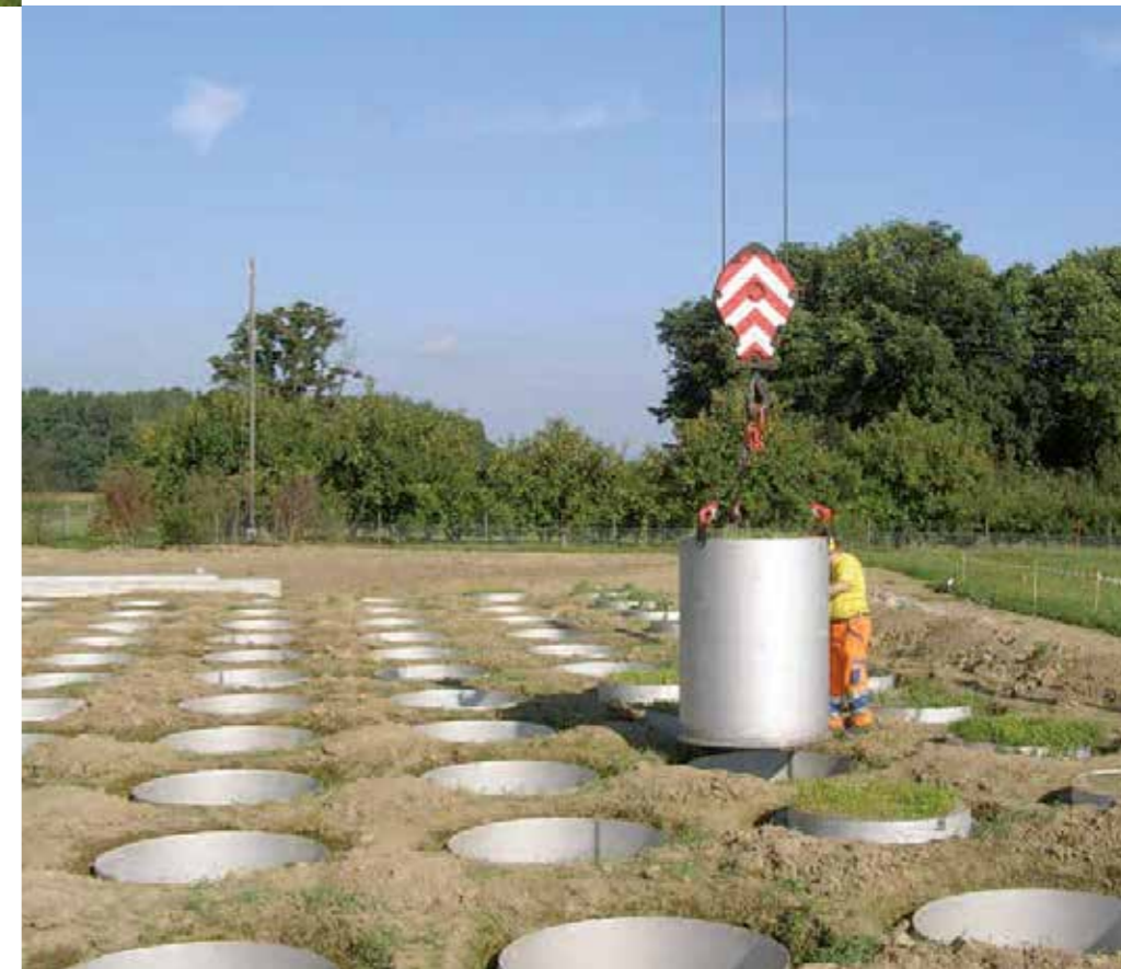
Dopo il trasporto dal luogo di prelievo, il monolito viene inserito nell'impianto lisimetrico
