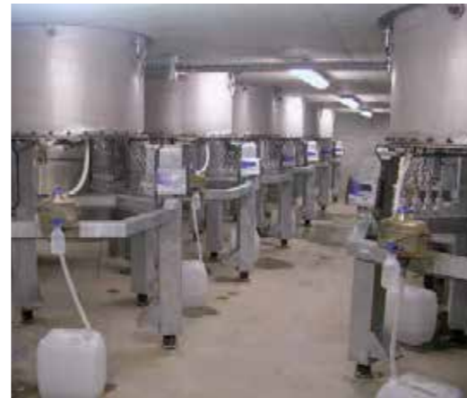
Lisimetri in posizione di pesatura, con misurazione del percolato (recipienti)
