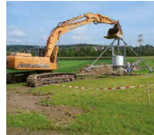
I monoliti per l'impianto lisimetrico sono stati prelevati in terreni tipici dell'Altopiano svizzero, a Schafisheim, Zurigo-Affoltern (area dell'ART di Reckenholz) e Grafenried
