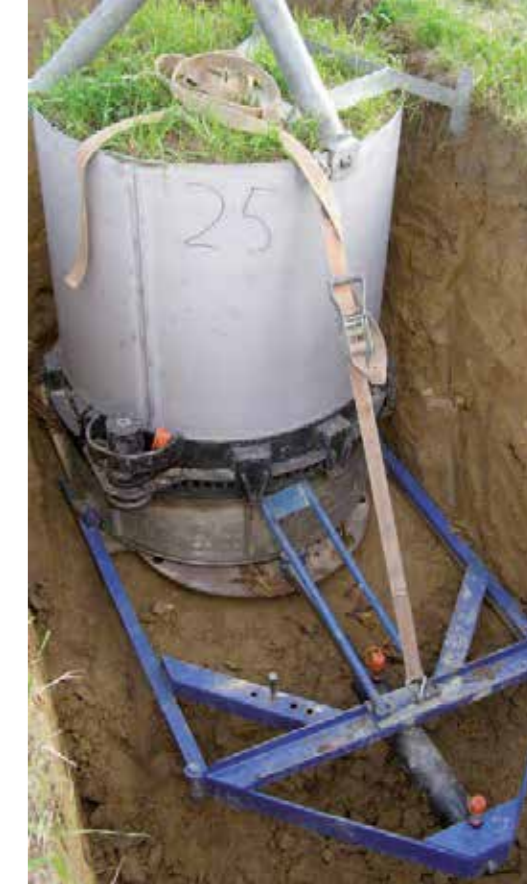
Carotaggio del monolito di terreno agrario indisturbato
