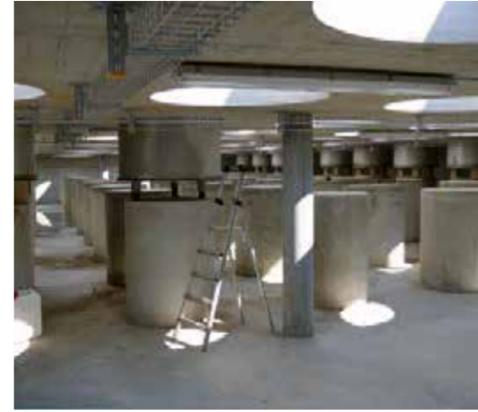
Lysimètres ne permettant pas la pesée
