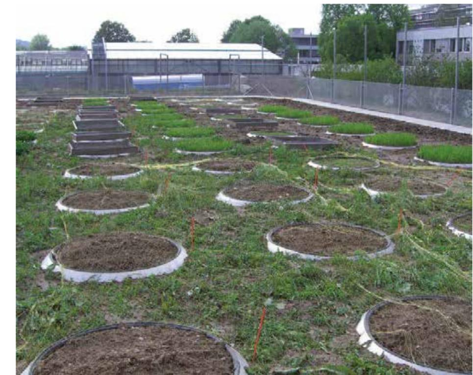
Installation des lysimètres après achèvement des travaux (sans protection contre les oiseaux). Le sous-sol est couvert d'humus et semé.
