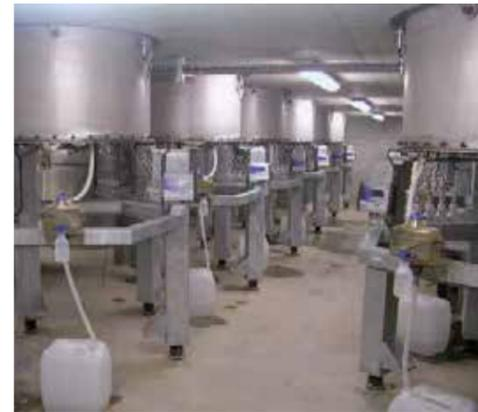
Lysimètres en position de pesée avec mesure de l'eau d'infiltration (conteneurs)
