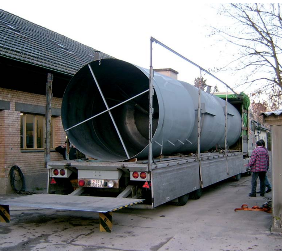
Anlieferung der Wärmespeicher
